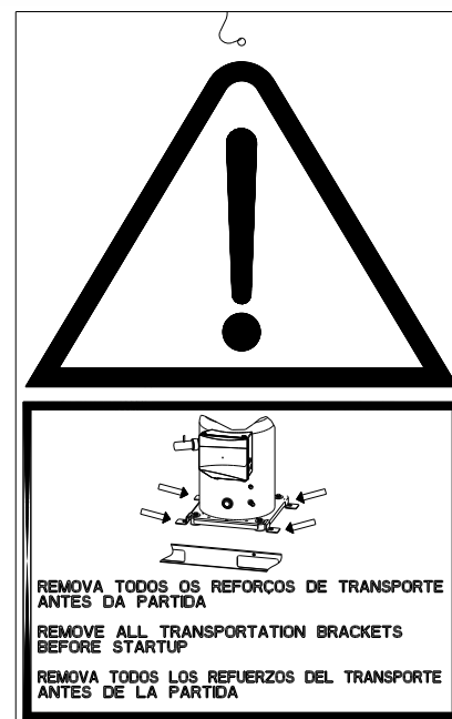
Fig. 6 - Destramento do compressor (Unidades 25TR)
