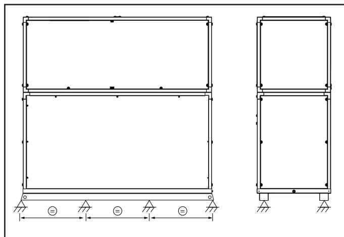
Figura 17 - Instalação típica com apoios individuais
