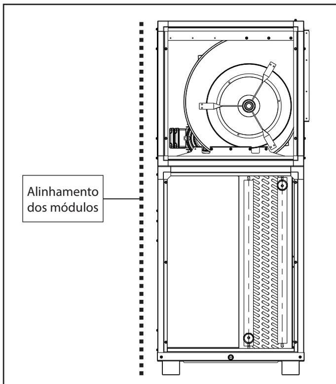
Figura 7 - Alinhamento de montagem dos módulos
