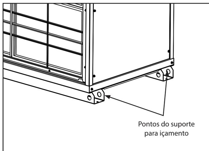
Figura 4 - Indicação dos pontos de suporte para içamento
