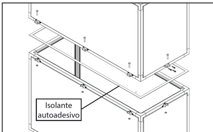
Figura 6 - Posição do auto adesivo isolante nos módulos
