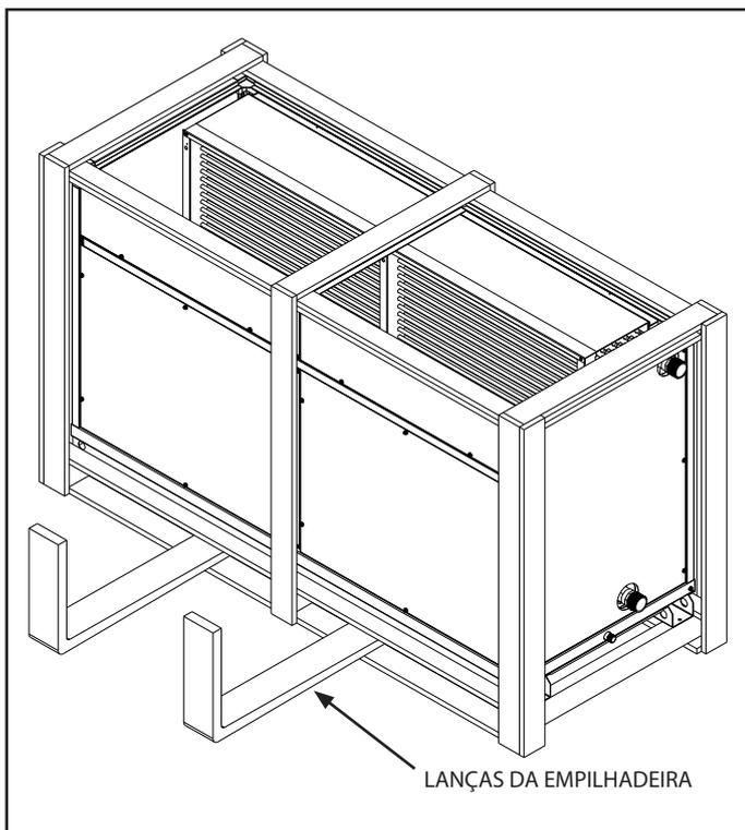
Figura 1 - Local para posicionamento das lanças da empilhadeira
