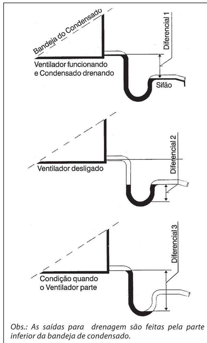
Obs.: As saídas para drenagem são feitas pela parte inferior da bandeja de condensado.
