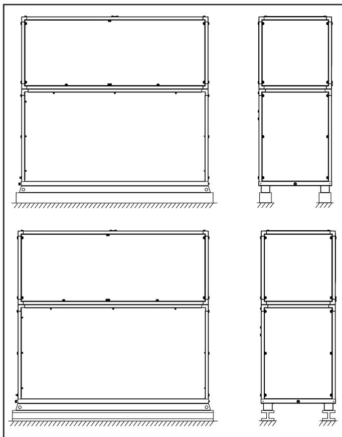
Figura 16 - Instalação típica com base plataforma
