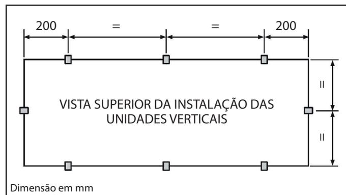
Figura 8 - Distância entre os pontos de fixação
