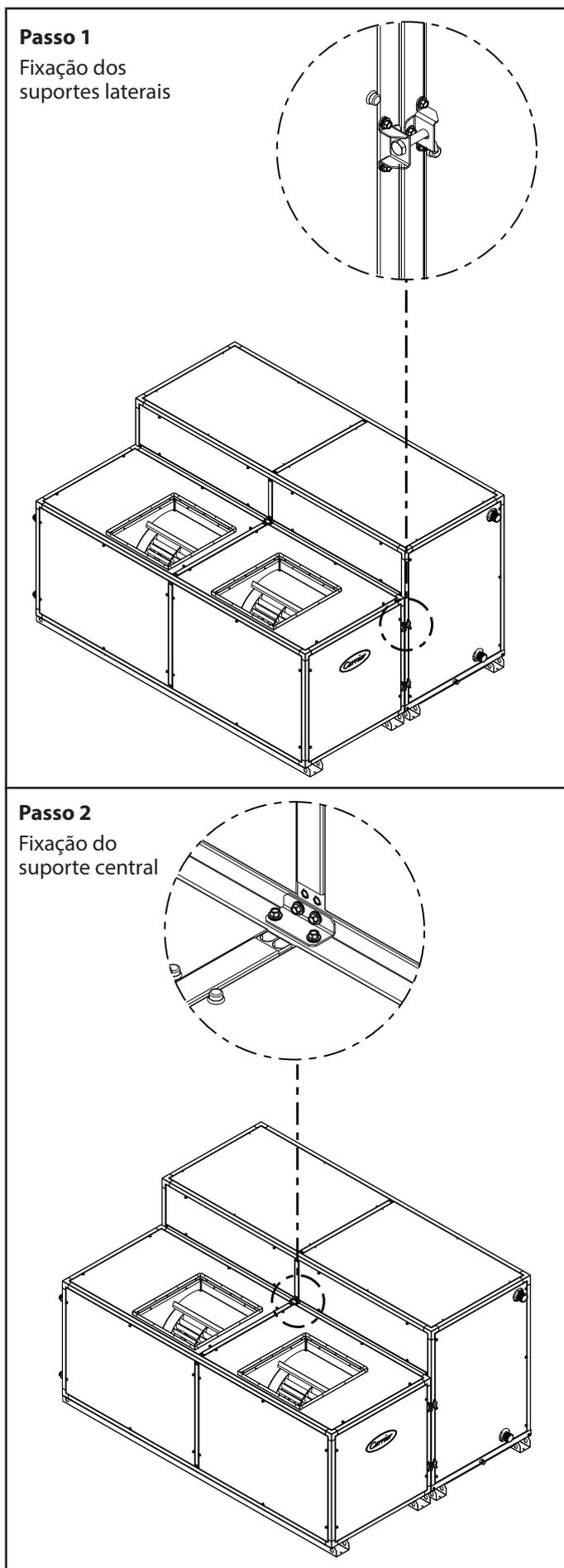
Figura 10 - Detalhe de fixação dos módulos para montagem horizontal
