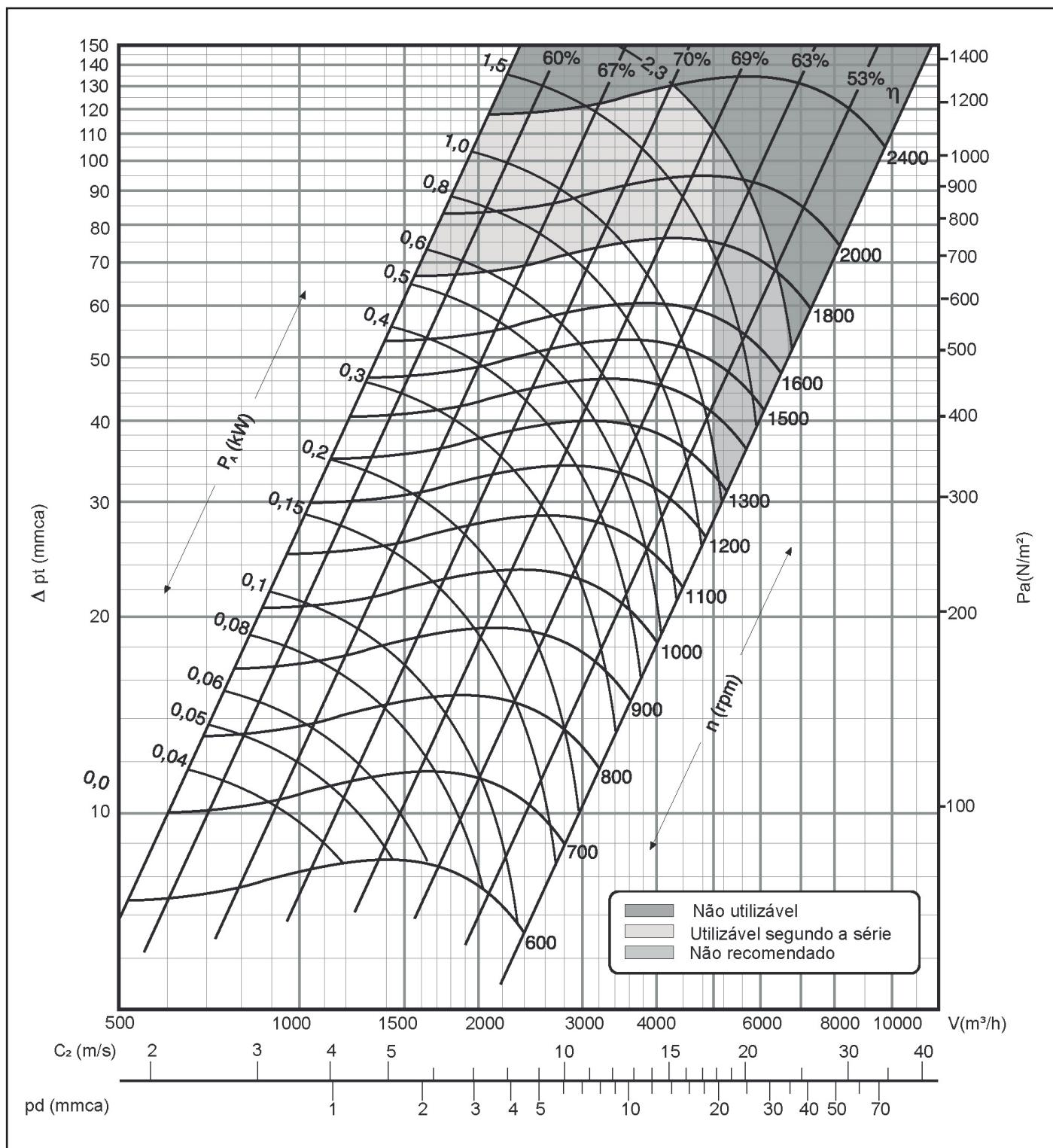
**39D12 - Curvas de vazão dos ventiladores - Sirocco 12-9**
