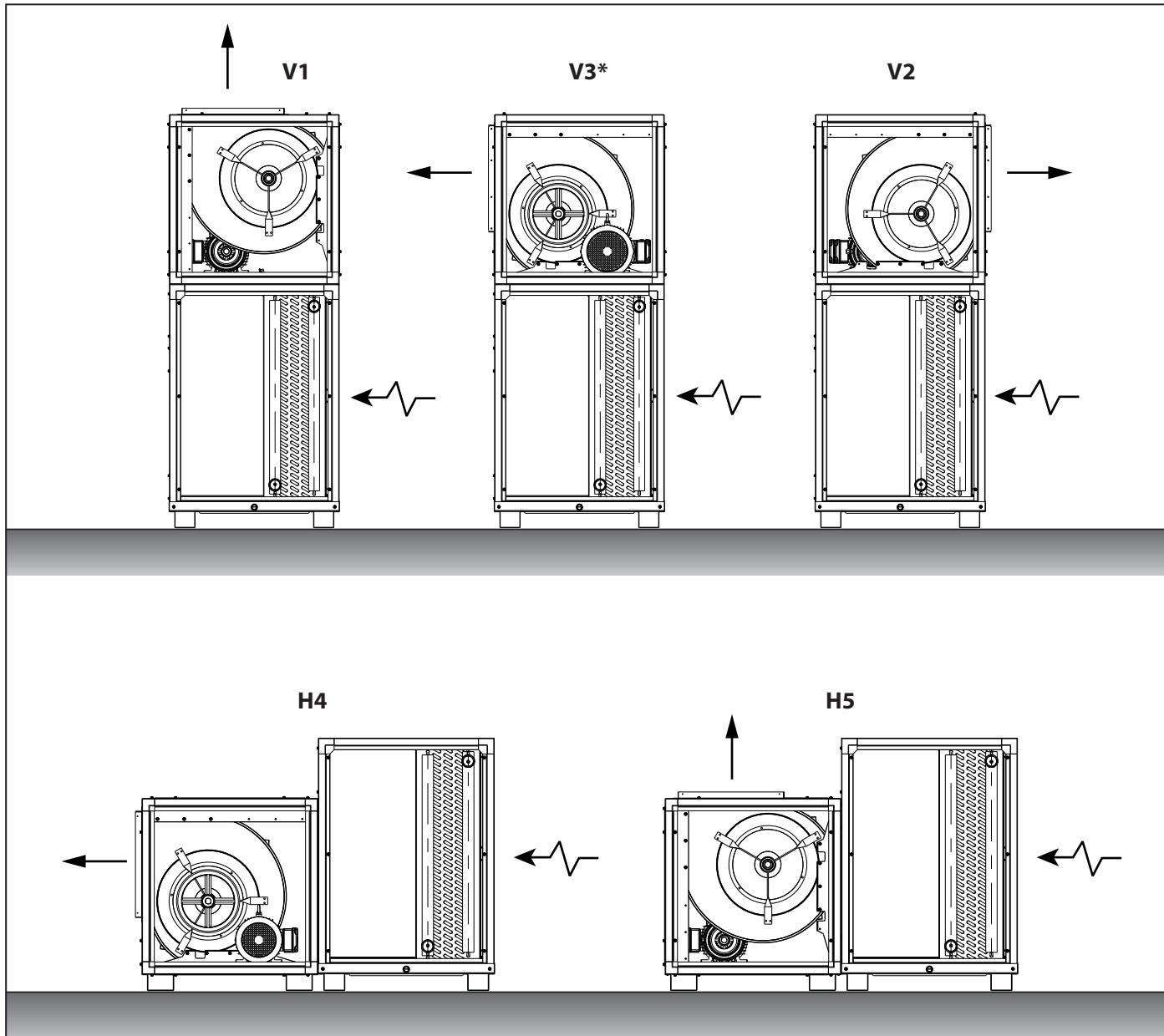
Posição Montagem Módulo Ventilador
