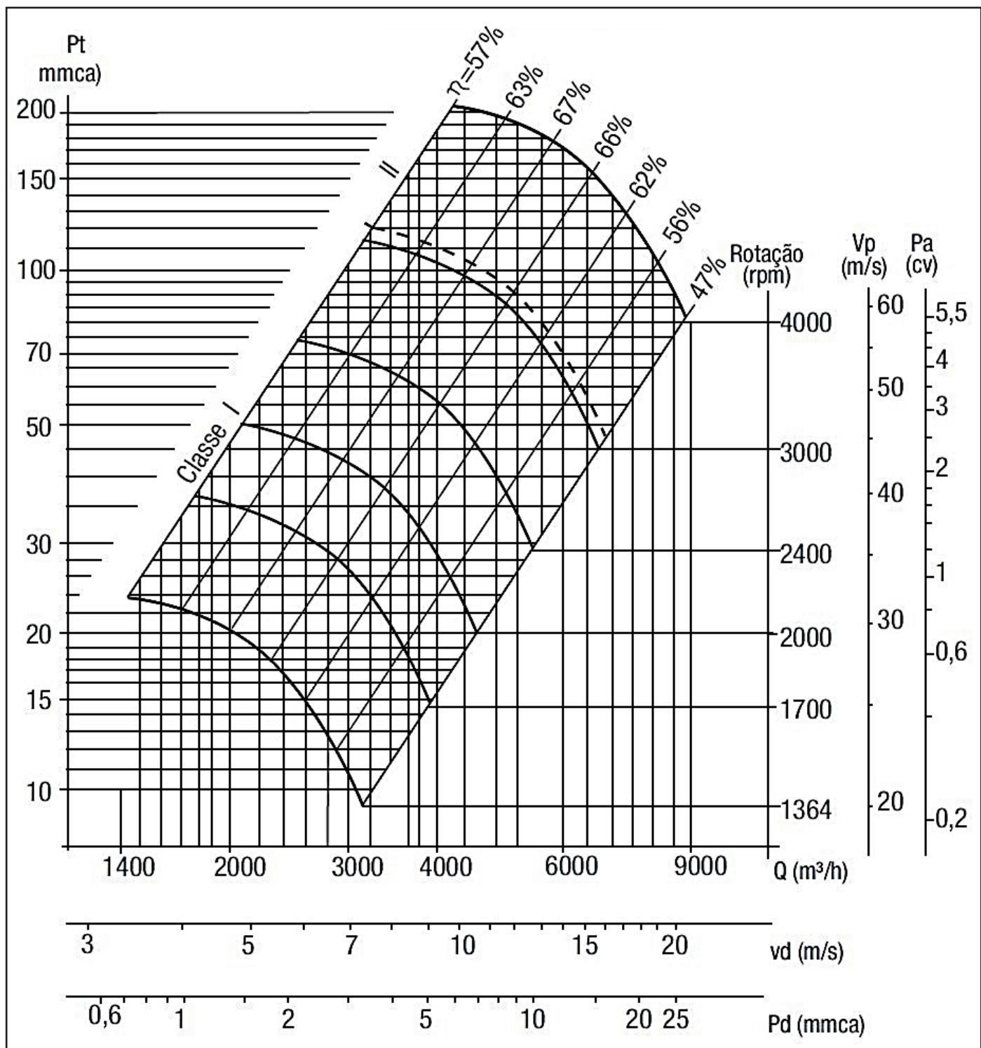
Ventilador Alta Pressão Estática (Limit Load)
