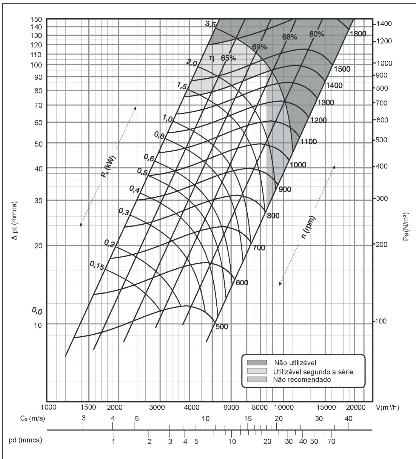
**39D18 / 39D20 / 39D23 - Curvas de vazão dos ventiladores - Sirocco 15-15**
