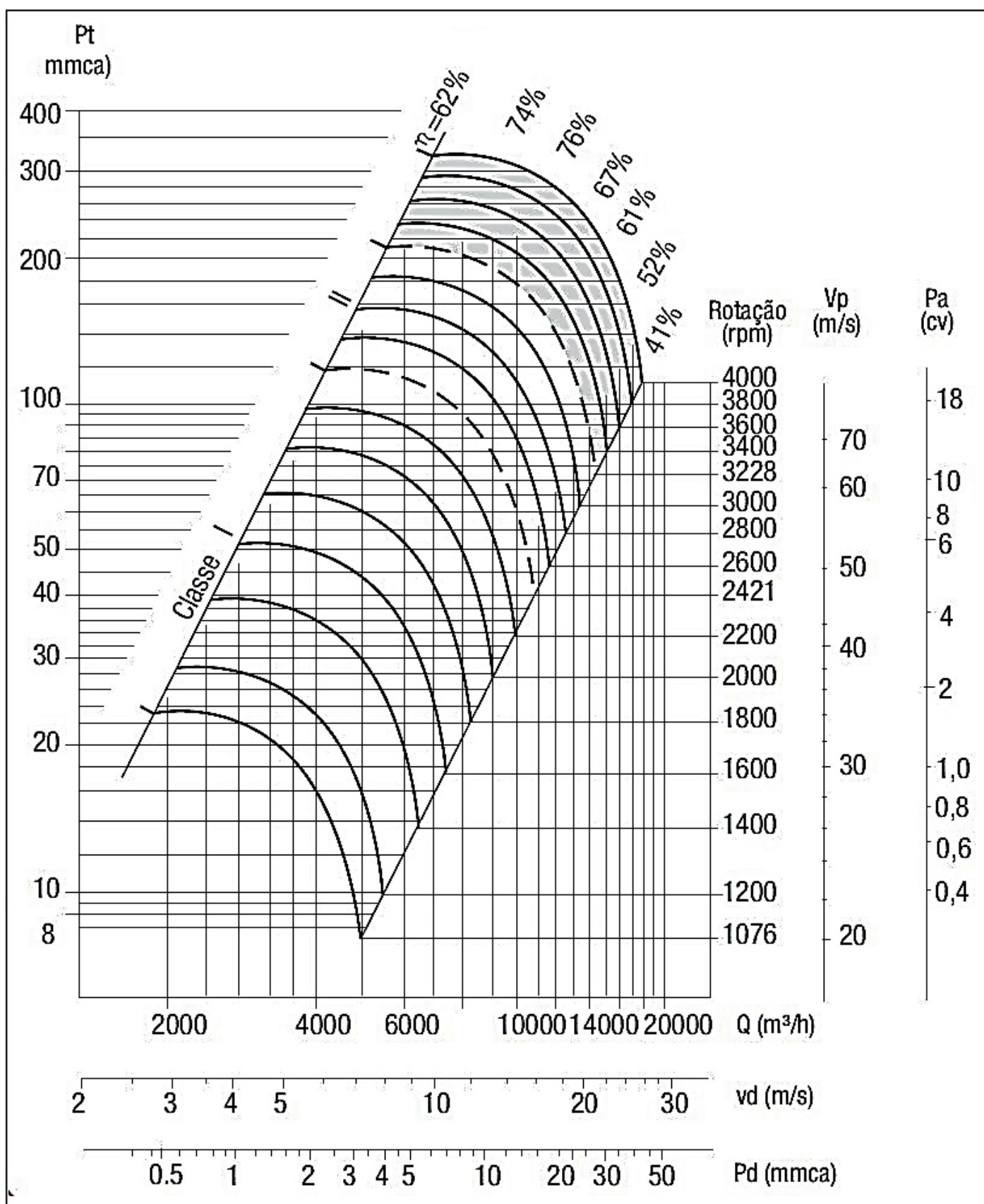
Ventilador Alta Pressão Estática (Limit Load)
