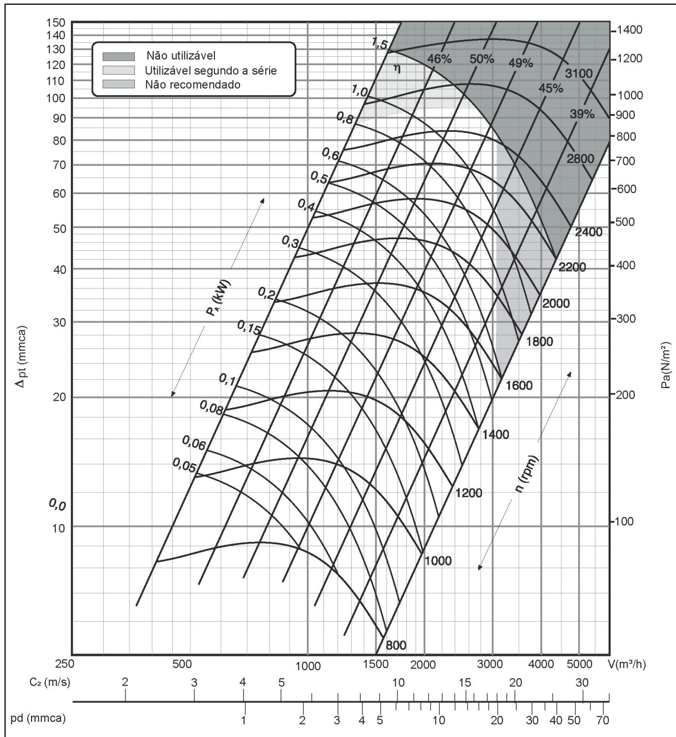
**39D05 / 39D10 - Curvas de vazão dos ventiladores - Sirocco 10-10**
