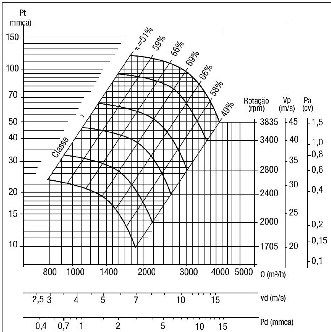
Ventilador Alta Pressão Estática (Limit Load)
