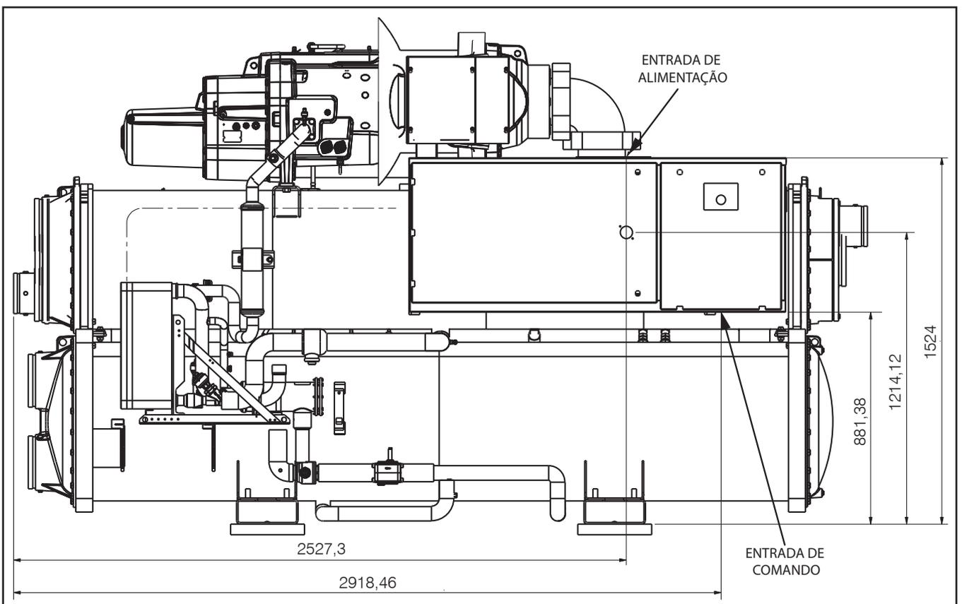
Fig. 2 – Dimensões da Caixa Elétrica - Unidades 30XW150-200 (cont.)
