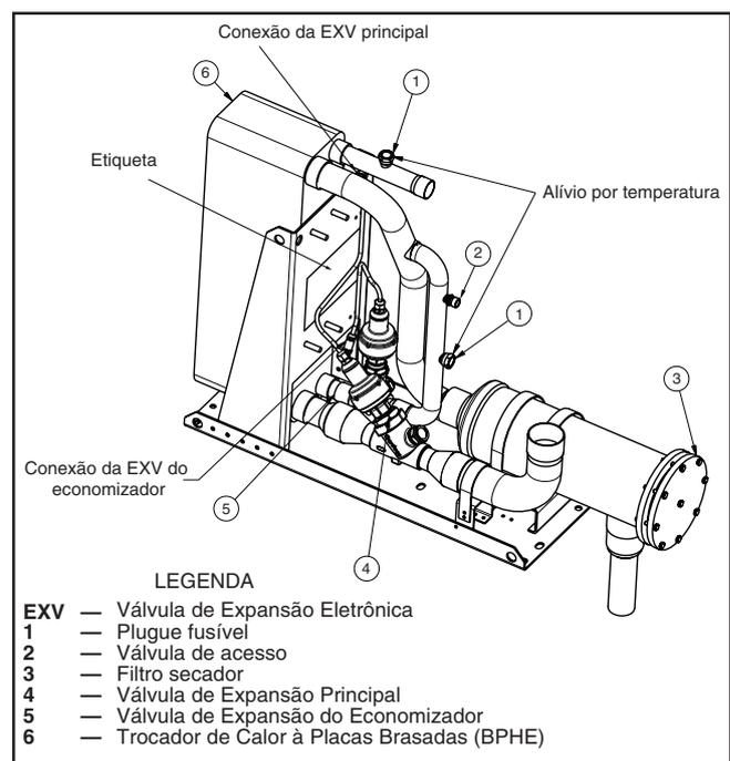
Fig. 13 – Montagem Típica do Economizador
