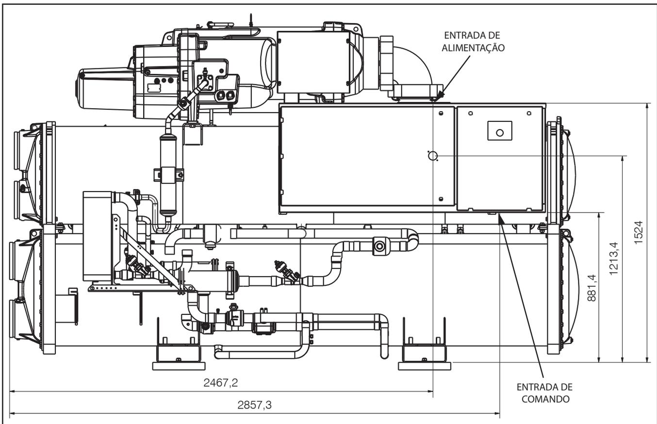
Fig. 3 – Dimensões da Caixa Elétrica - Unidades 30XW225-300 (cont.)
