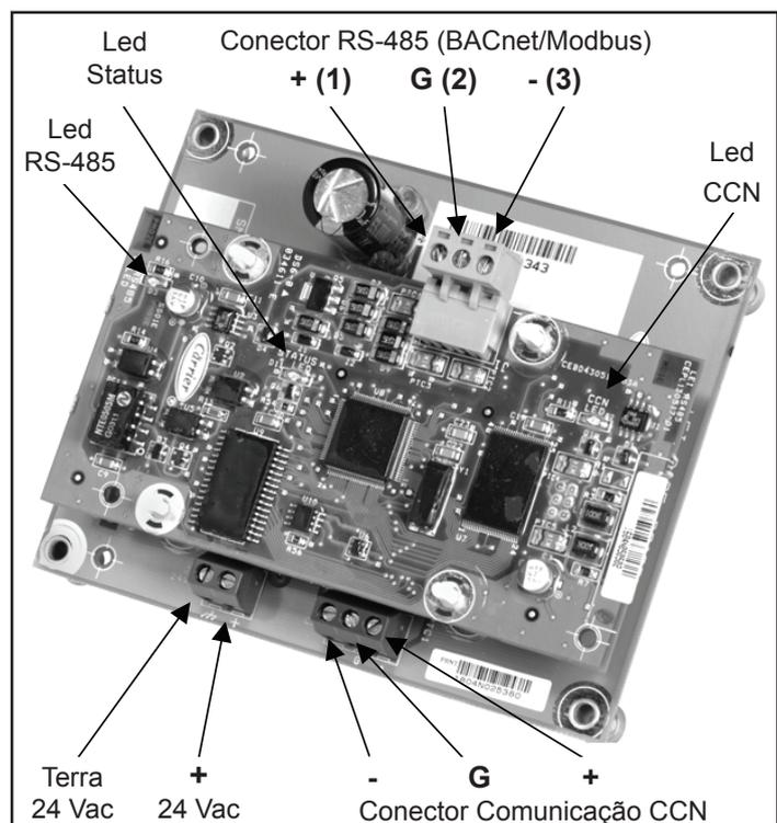
**Fig. 20 - Placa Tradutor BACNet/Modbus**
