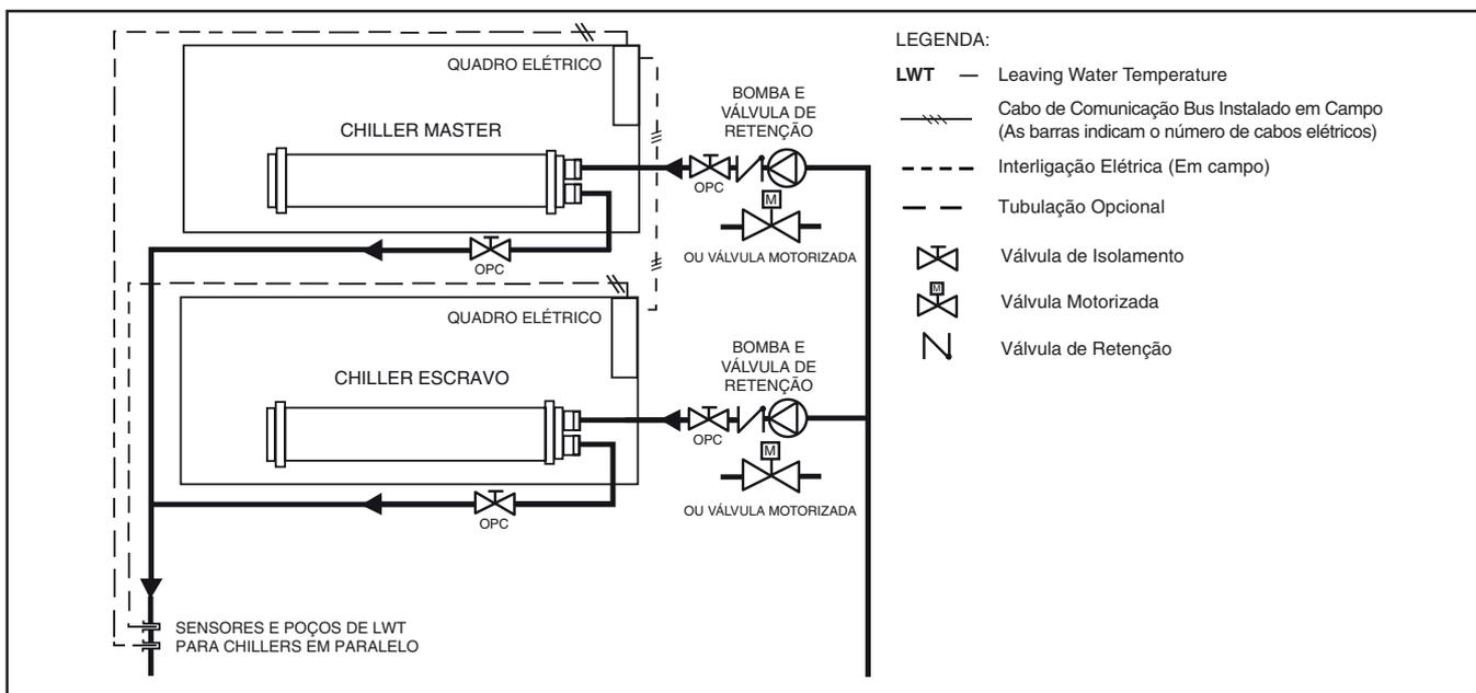
Fig. 15 - Operação de chillers duplos em paralelo
