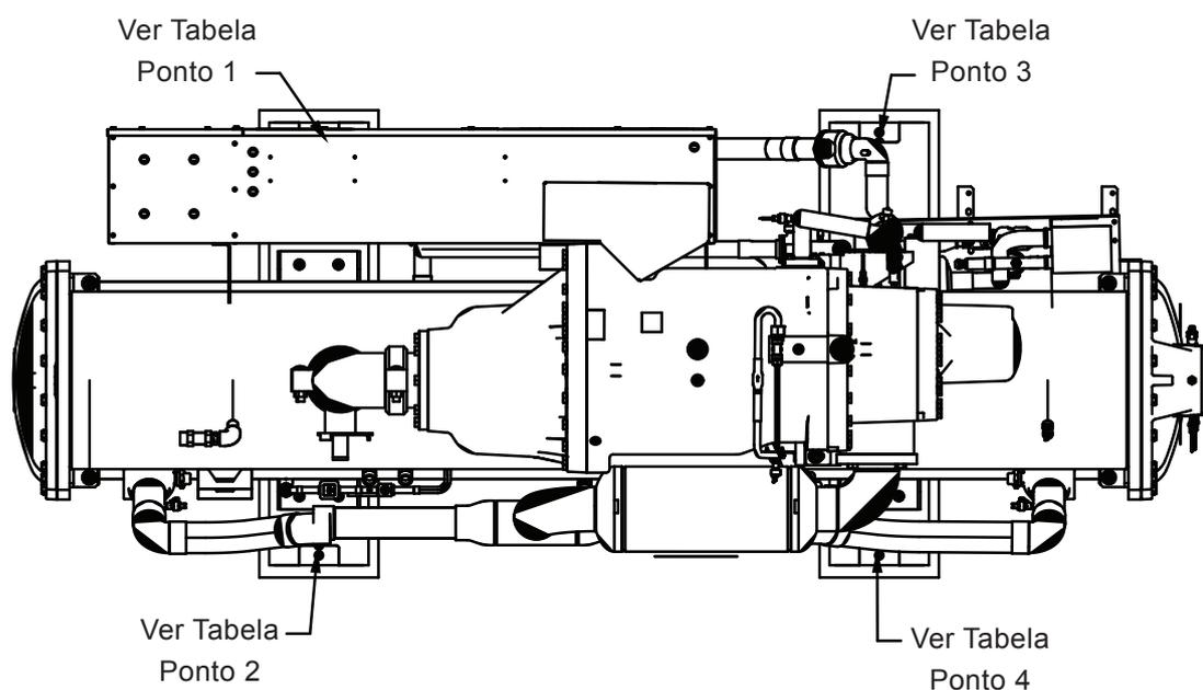
**Fig. 25 - Detalhe de Alocação dos Isoladores de Vibração**
