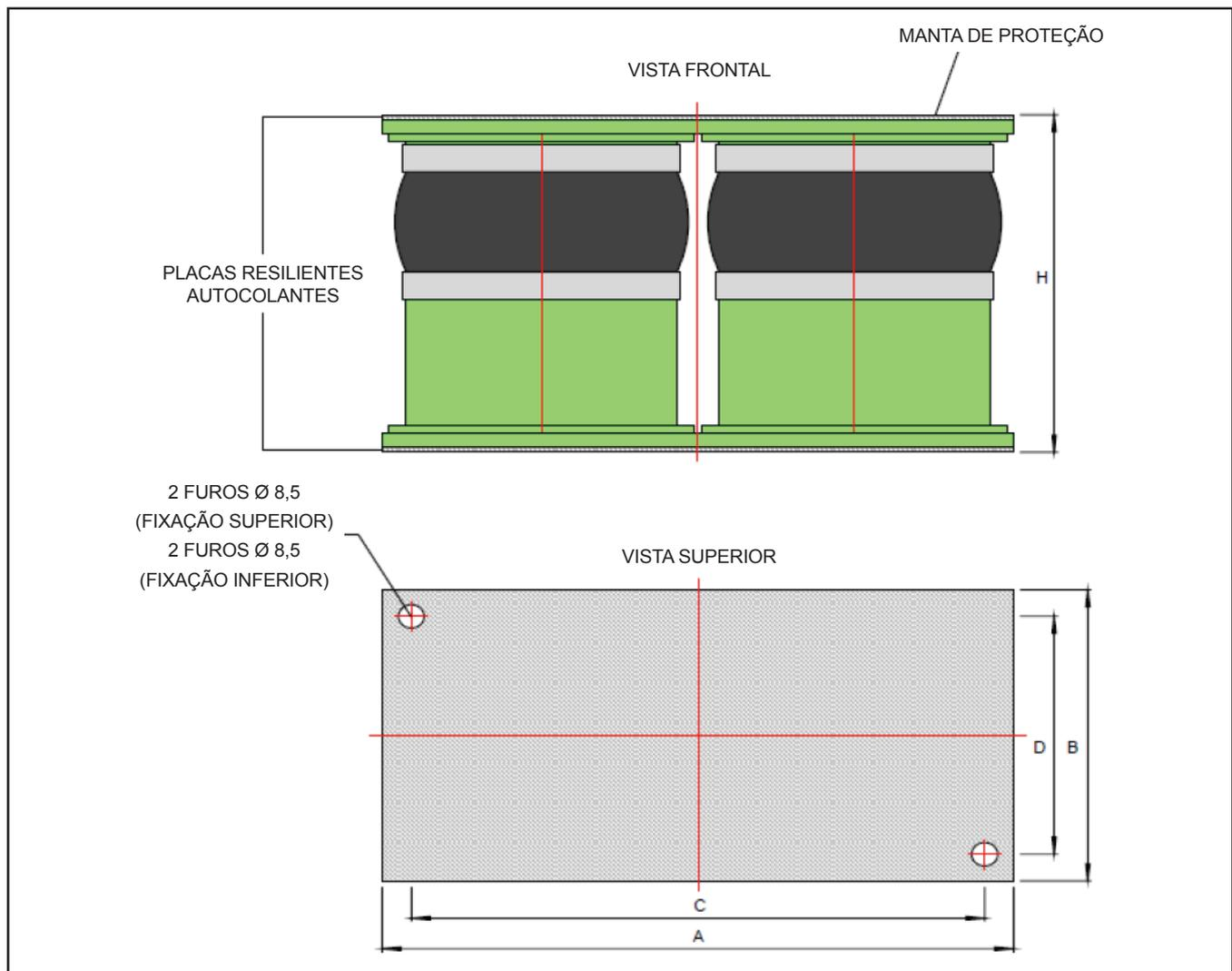
**Fig. 23 - Dimensões do Isoamortecedor de Vibrações**
