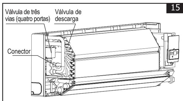
Após a primeira purga, faça o ar sair completamente das serpentinas através da válvula de purga.
