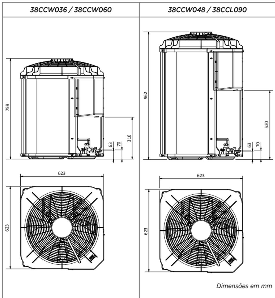
FIG. 14 - DIMENSIONAL UNIDADES CONDENSADORAS 38C
