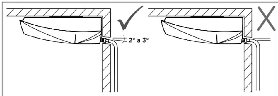
FIG. 22 - INCLINAÇÃO DRENAGEM
