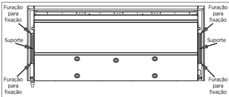
FIG. 18 - SUPORTES E FURAÇÃO PARA FIXAÇÃO
