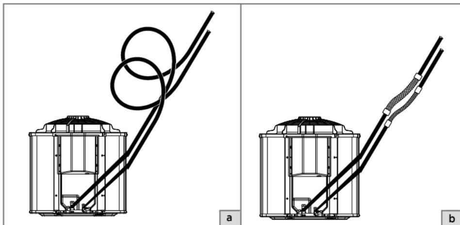
FIG. 25 - INSTALAÇÃO DOS LOOPS
