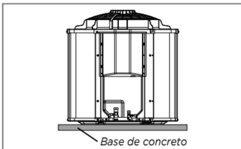
FIG. 4 - BASE RESISTENTE PARA INSTALAÇÃO
