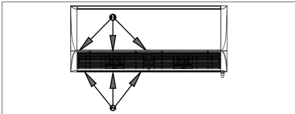
FIG. 20 - POSIÇÃO DOS PARAFUSOS PARA DESMONTAGEM DAS GRELHAS
