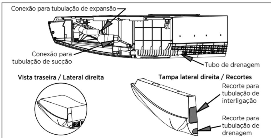
FIG. 21 - TUBULAÇÕES DE INTERCONEXÃO E DRENAGEM
