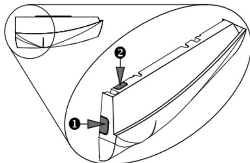
FIG. 34 - Detalhamento caixa elétrica da evaporadora e conexões
