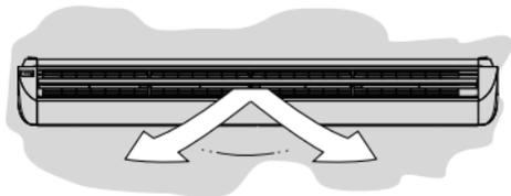
Regular **manualmente** os defletores verticais para alterar a direção do fluxo de ar para a direita, ao centro ou para a esquerda, movendo as alavancas dos defletores (a posição destas poderá variar conforme o modelo).
