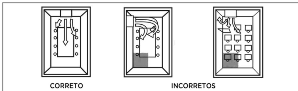
FIG. 17 - POSIÇÃO DA EVAPORADORA NO AMBIENTE
