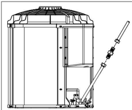
FIG. 32 - Instalação do kit sistema de expansão
