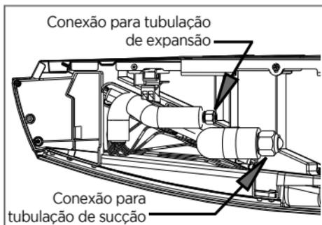
FIG. 26 - EX. CONEXÕES DE INTERLIGAÇÃO
