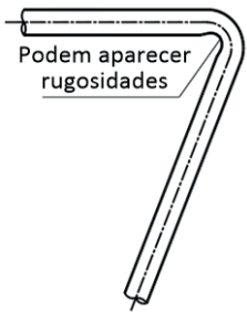
Figura 3-4.3: Tubulação com curvatura superior a 90°
