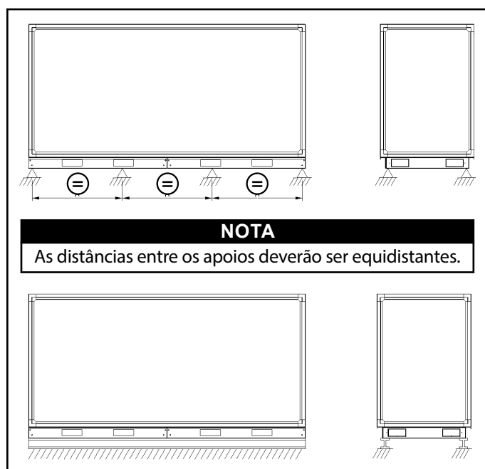
Fig. 2 - Instalação típica - Unidades com base metálica
