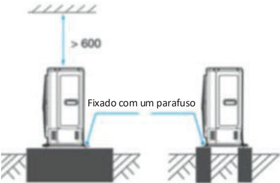
Figura 2-3.2: Vista lateral da instalação da unidade individual (unidade: mm)
