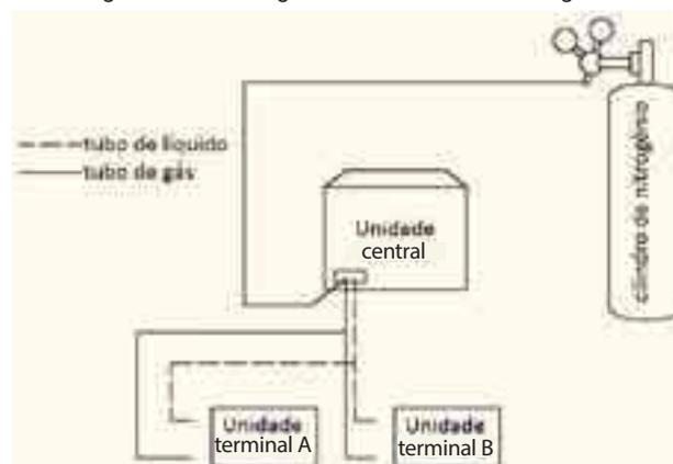
Figura 3-4.10: Sequência de lavagem dos tubos<sup>1</sup>
