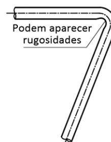
Figura 3-5.3: Curva de tubo com mais de 90^\circ
