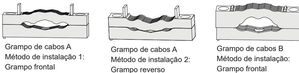
5. Ao instalar diferentes tipos e diâmetros de cabos de alimentação, são usados diferentes métodos de grampeamento para garantir que os grampos de cabo possam ser usados para comprimir os cabos de alimentação e evitar que os terminais sejam tensionados quando os cabos de alimentação são puxados. (Observação: Quando for usar o método de grampeamento 1, verifique se cada cabo de energia está duplamente isolado)
