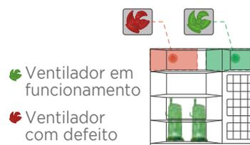
*Operação automática de apoio de outro ventilador em caso de falha de um dos ventiladores*
