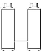
Tubulação de balanceamento de óleo entre o separador de gás e líquido garante a distribuição equilibrada de óleo para manter o funcionamento normal dos compressores.
