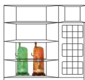
*O funcionamento continua em caso de falha de um compressor*
