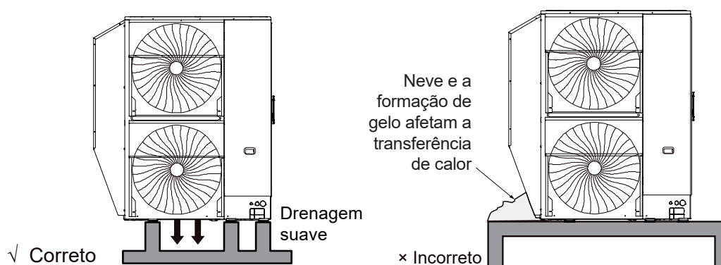
Figura 3-3.12: Direção de instalação com proteção contra neve
