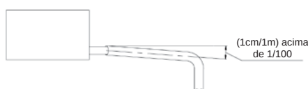
Figura 3-6.1: Requisito de inclinação mínima da tubulação de drenagem
