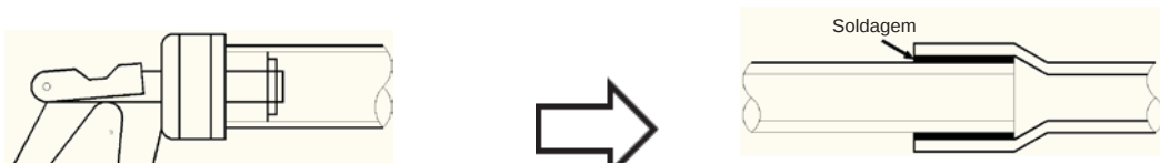
Figura 3-5.1: Expansão das extremidades da tubulação de cobre
