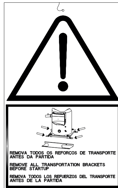
Fig. 6 - Destramamento do compressor (Unidades 25TR)
