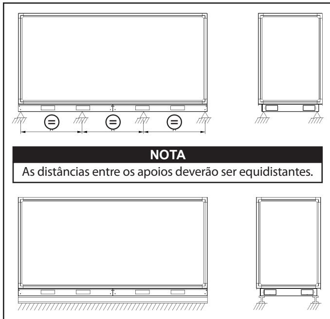
Fig. 4 - Instalação típica - Unidades com base metálica
