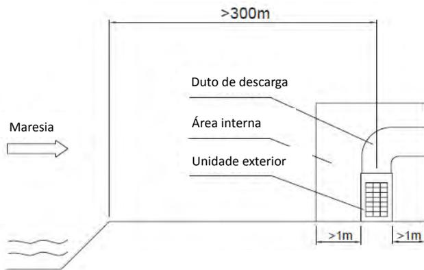
Figura 3-10.2: Instalação exterior sob uma cobertura
