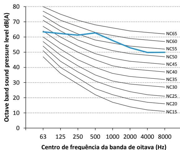
Figura 2-10.8 38VF020H119015 nível da banda de oitava
