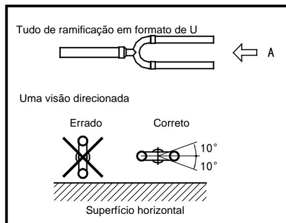
Figura 3-5.9: Instalação de articulações exteriores
