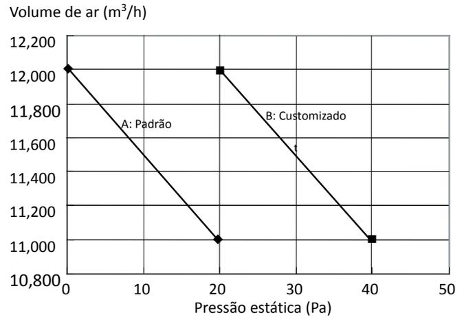
Figura 3-3.8: Performance dos ventiladores de 14HP e 16HP
