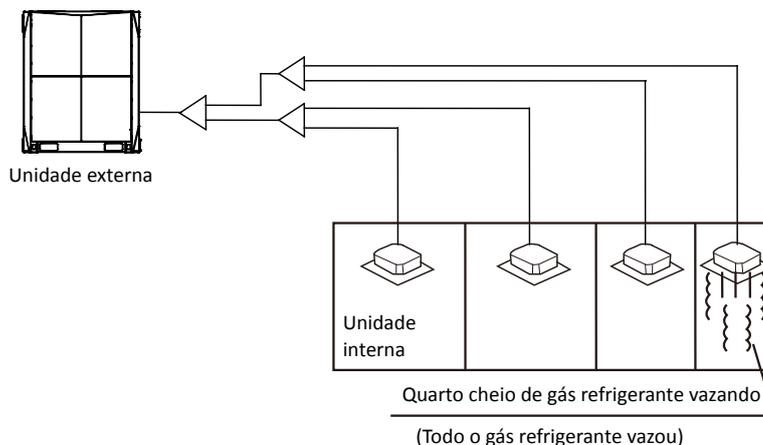
Figura 3-4.7: Ventilador mecânico controlado por detector de vazamento de refrigeração
