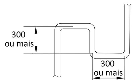
Figura 3-4.2: Comprimentos de tubulação de refrigeração permitidos e diferenças de nível
