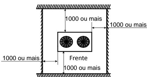
Figura 3-2.2: Instalação de unidades em linha (unidade: mm)
