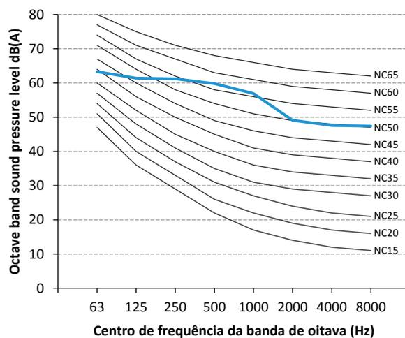
Figura 2-10.6 38VF016H119015 nível da banda de oitava
