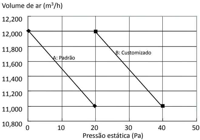
Figura 3-3.7: Performance do ventilador de 12HP
