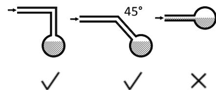
Figura 3-6.4: Efeito de suporte insuficiente da tubulação de drenagem
