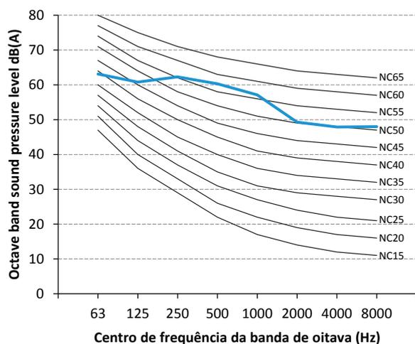
Figura 2-10.7 38VF018H119015 nível da banda de oitava
