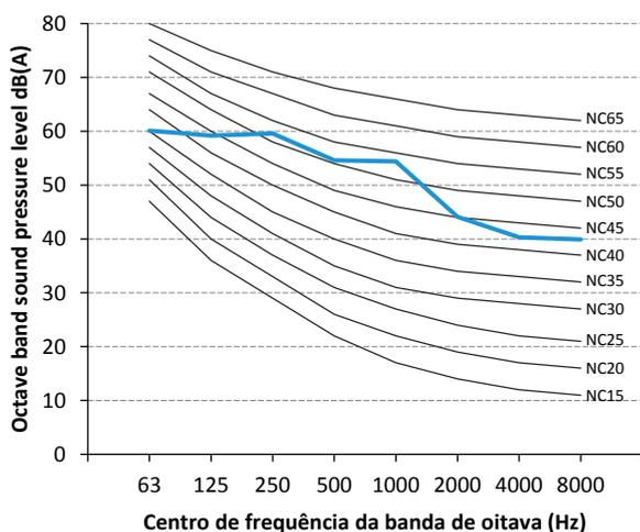
Figura 2-10.3 38VF010H119015 nível da banda de oitava
