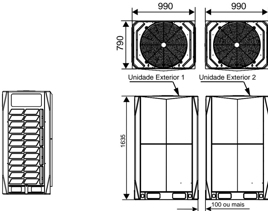
38VF026H119015 / 38VF028H119015 / 38VF030H119015 / 38VF032H119015 / 38VF034H119015
