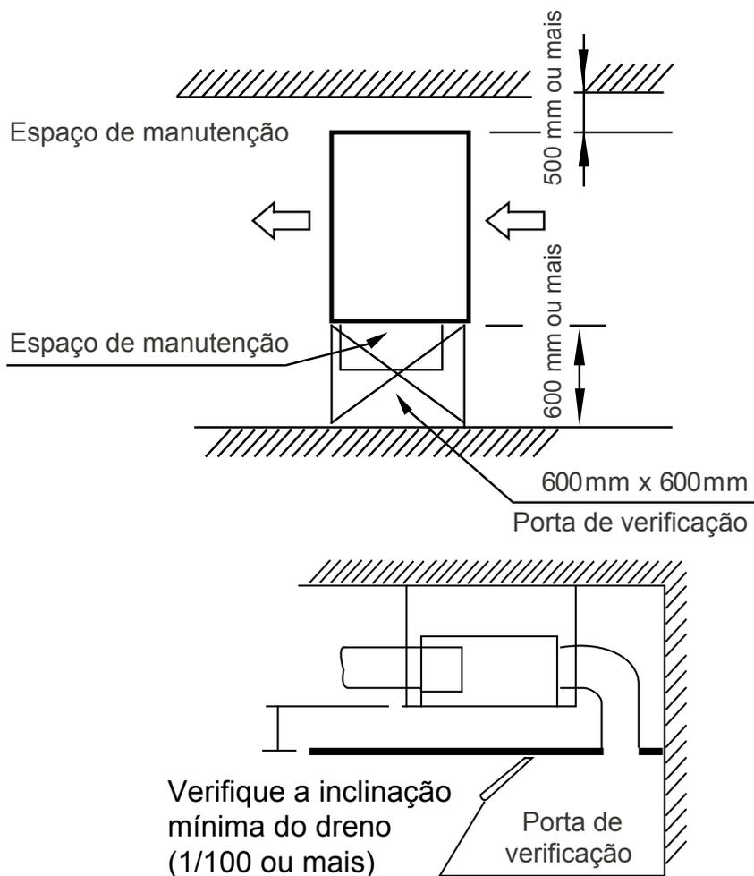
1. A entrada e a saída de ar devem estar afastadas o suficiente para evitar interferência entre a saída e a entrada de ar.
