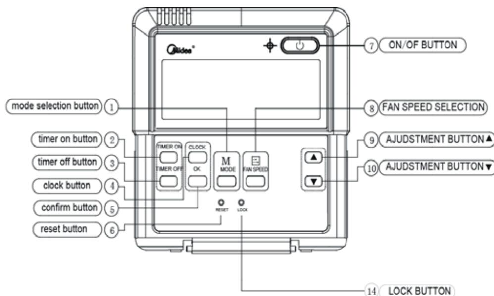
As condições básicas de operação do controle com fio encontram-se a seguir:
