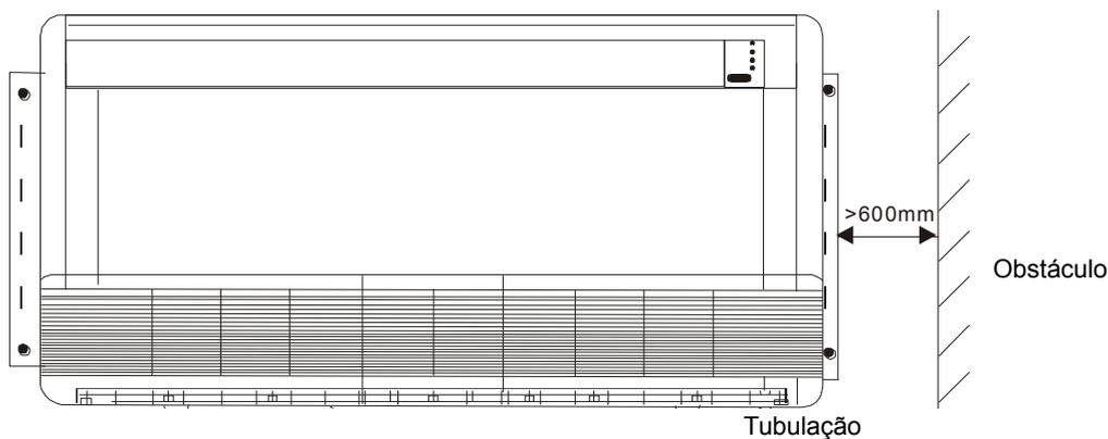
Mantenha uma distância de 600mm entre a unidade e a parede lateral esquerda/direita.
