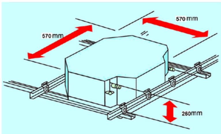
O modelo possui saída de ar em 360°, possibilitando uma circulação do ar mais uniforme no ambiente. O alto fluxo de ar pode maximizar o condicionamento do ar em salas com mais de 3 metros de altura.
