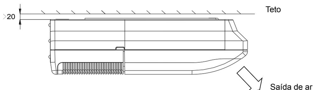
Mantenha 20mm entre a parte traseira e a parede se estiver instalada na vertical. Mantenha 20mm entre a parte superior da unidade e o teto se estiver instalada na horizontal.
