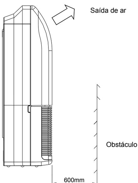
Mantenha o mínimo de 600mm entre o painel e a parede frontal para melhor ventilação
