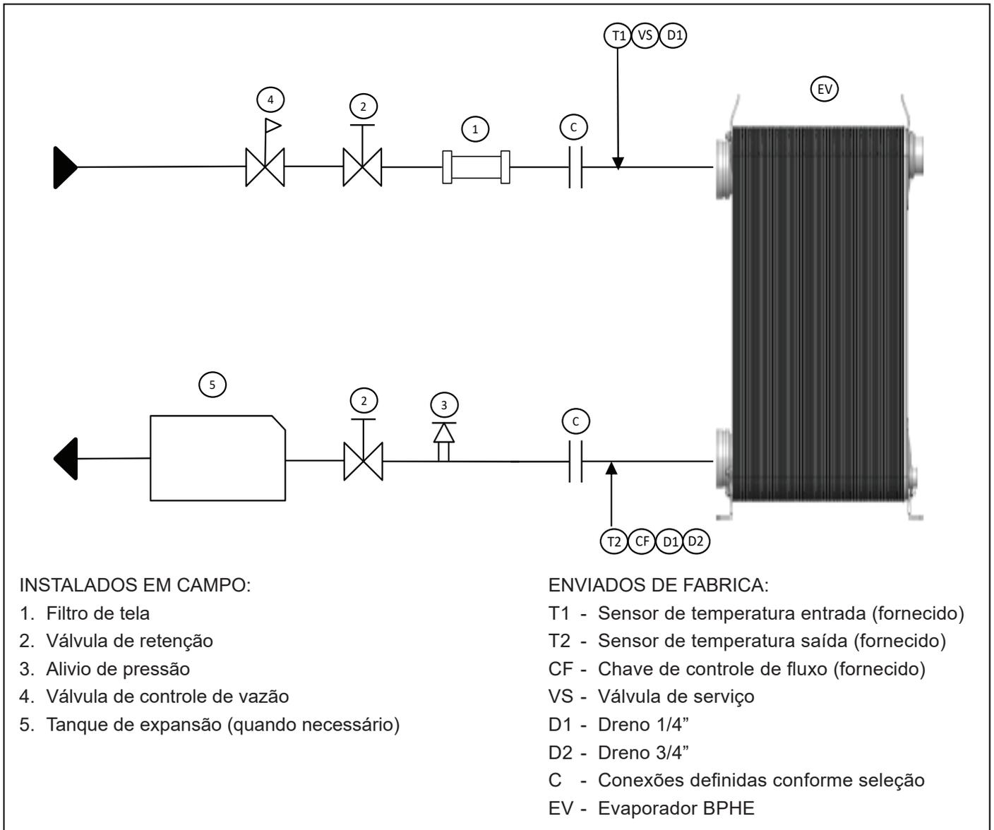
Figura 12 - Esquema típico de instrumentação do sistema
