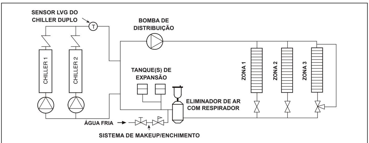
Figura 13 - Esquema chillers múltiplos com eliminador de ar
