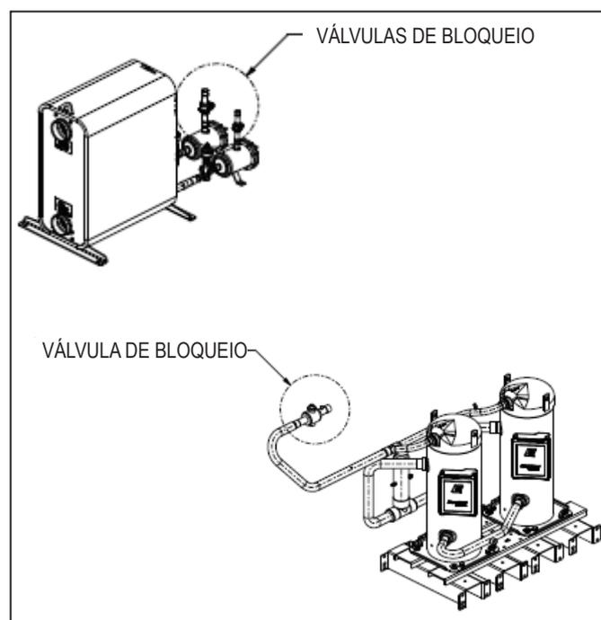
Figura 24 - Posição válvulas de bloqueios do sistema
