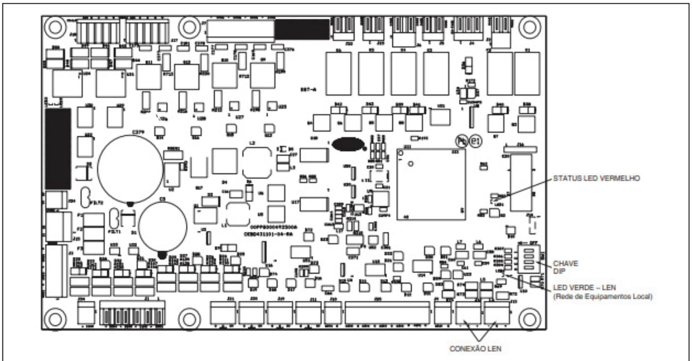
Figura 21 - Placa SIOB - Controle circuito A e B
