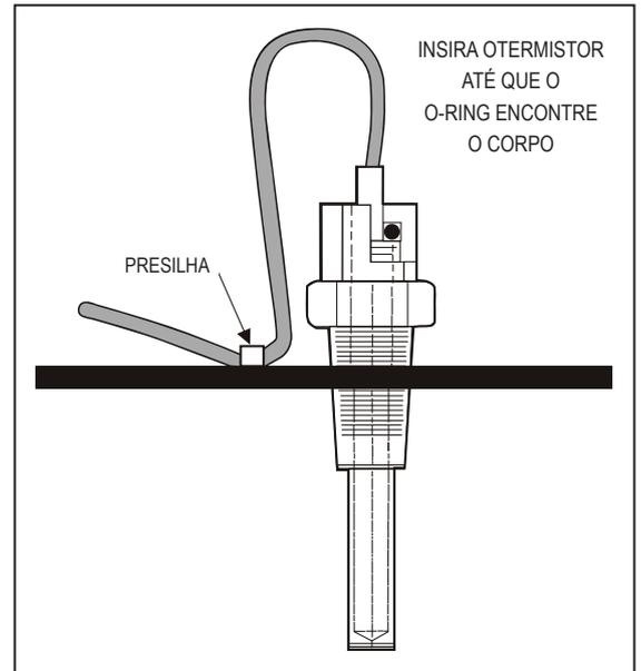
Figura 18 - Sensor para temperatura da água de saída
