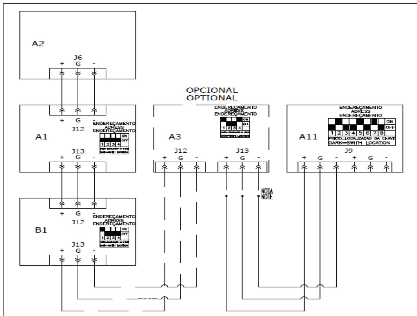
Figura 23 - Diagrama entre HMI e Placas eletrônicas
