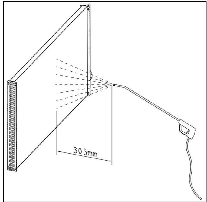
Figura 27 - Processo de limpeza serpentina
