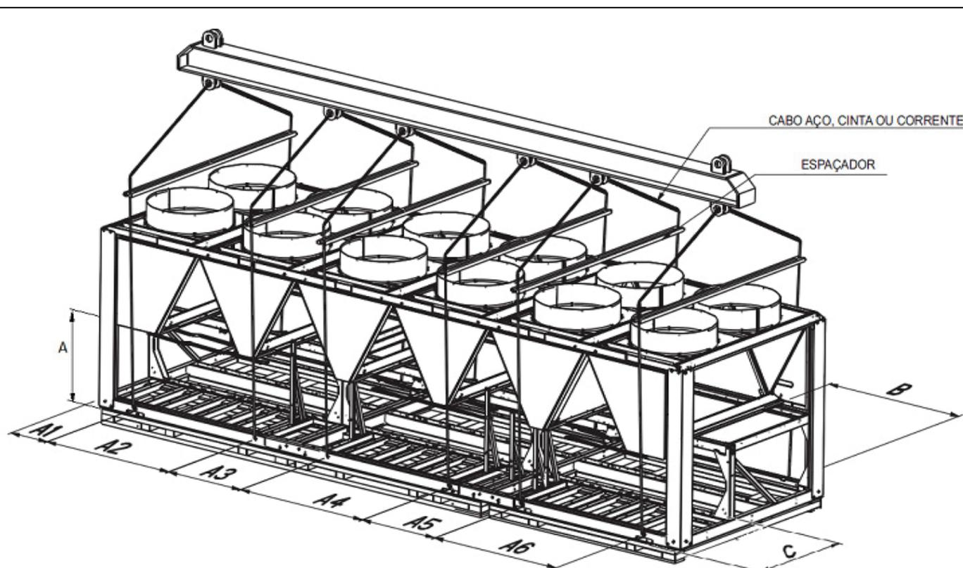
**A UNIDADE DEVE SER IÇADA POR TODOS OS PONTOS DE IÇAMENTO EXISTENTES NO CHASSI
