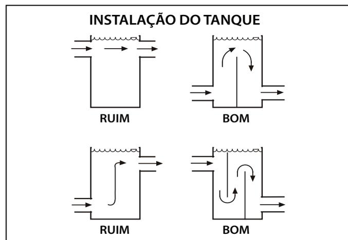
Figura 9 - Fluxo Tanque
