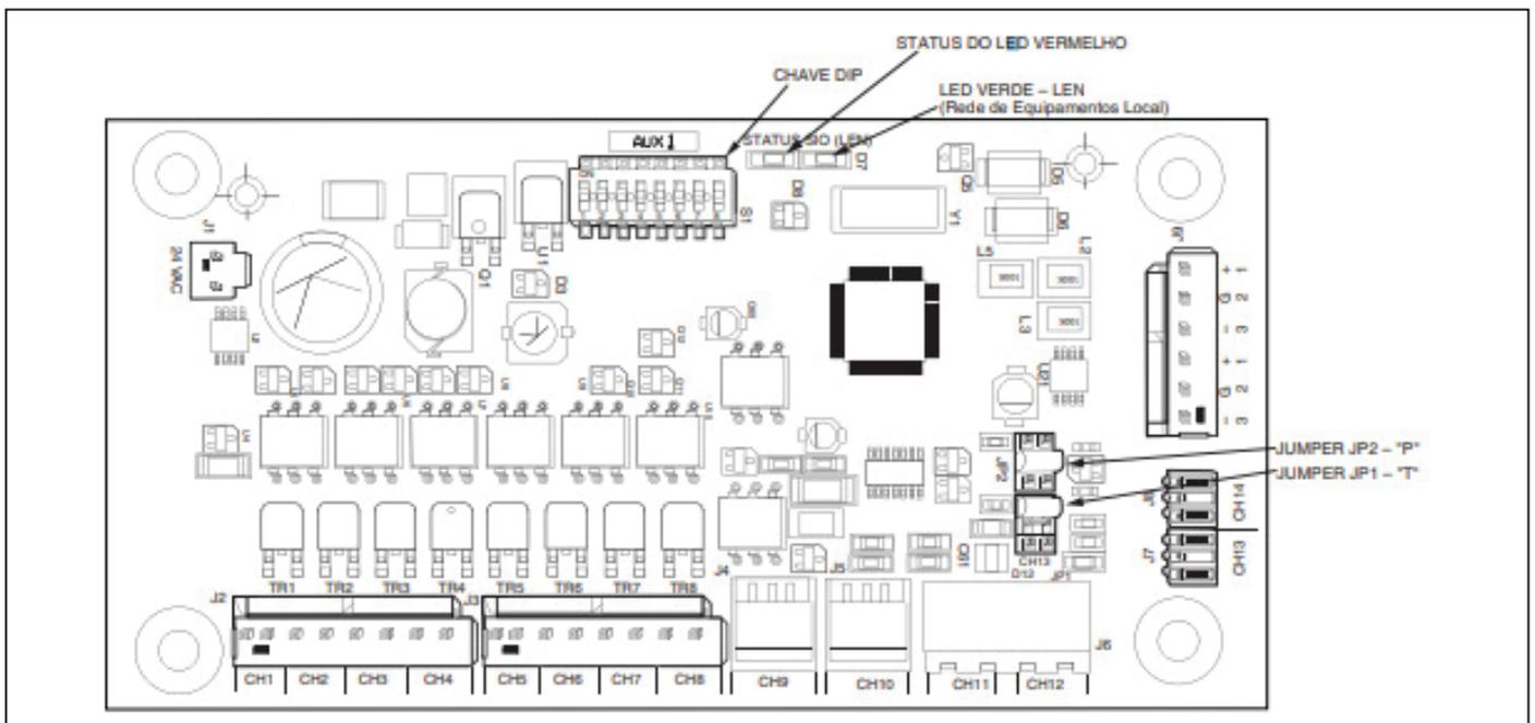
Figura 22 - Placa AUX A11 - Controle Ventiladores
