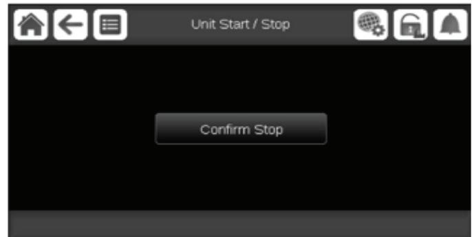
Para parar uma unidade em funcionamento, pressione o botão Iniciar/Parar "verde". Para métodos de controle da máquina Local On, confirme o desligamento da unidade pressionando Confirm Stop (tela acima) ou cancele pressionando o botão Back.
