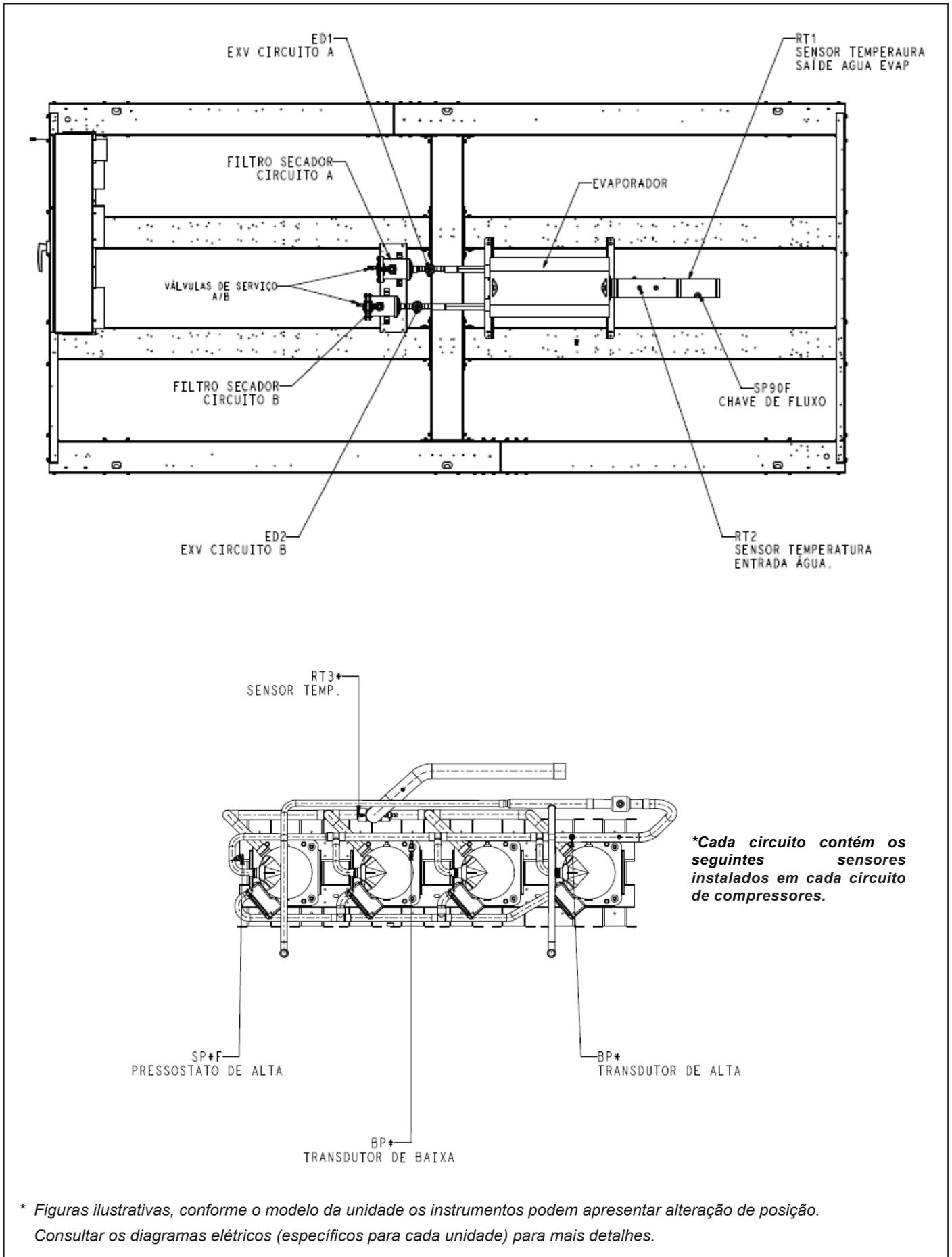
Figura 25 - Posição dos principais instrumentos do chiller
