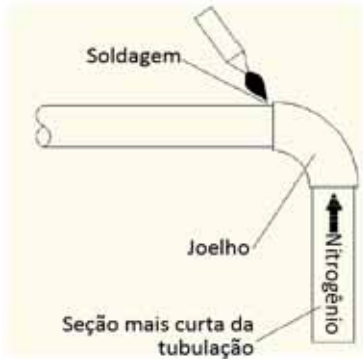
Figura 3-5.5: Fluxo de nitrogênio do lado mais curto durante a soldagem
