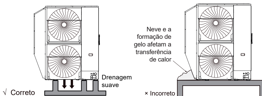
Figura 3-3.12: Direção de instalação com proteção contra neve
