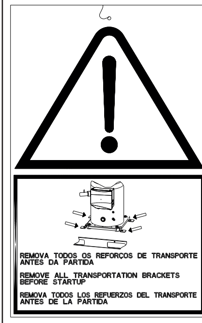
Fig. 6 - Destramento do compressor (Unidades 25TR)
